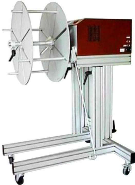
Le Dérouleur PFA-120, est un équipement conçu pour être installé en amont des machines de débit du marché, aussi bien les machines de coupe, que les machines de coupe/dénudage.
