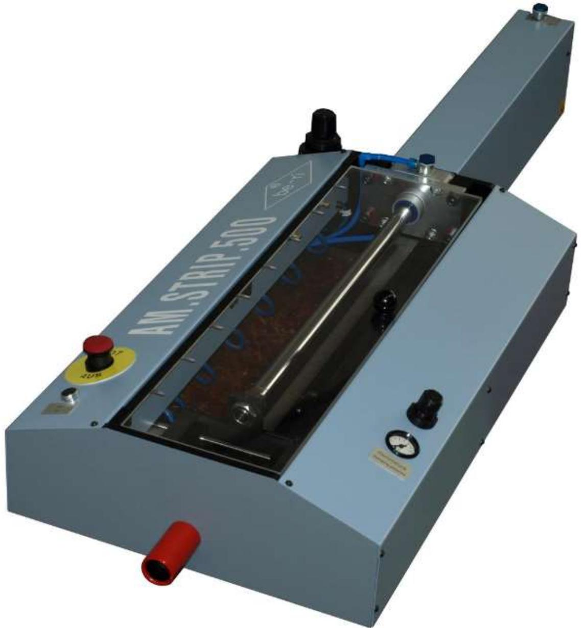
L'AM STRIP 500 est une machine pneumatique semi-automatique conçue pour retirer la gaine extérieure des câbles multiconducteurs dont le diamètre extérieur peut atteindre 30mm et sur une longueur de dénudage de 500 mm en course complète.
