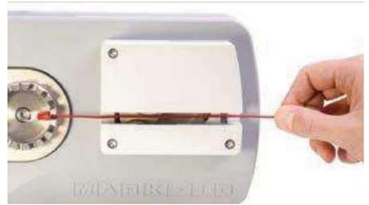
Le testeur démarre automatiquement l'essai lorsque l'échantillon est détecté, et retourne en position initiale lorsque ce dernier se rompt. Le carrousel réglable accueille des fils de diamètre extérieur allant jusqu'à 6.3mm
