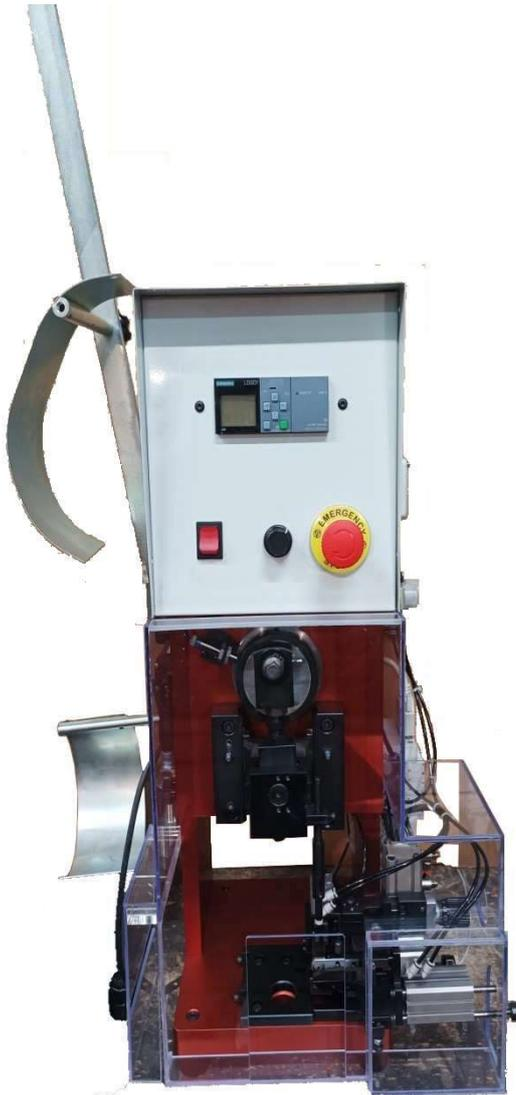
L'automate de dénudage et sertissage T20-STG01-P2 est une machine polyvalente et robuste, qui permet de simplifier les opérations de sertissage et d'en augmenter les cadences.
