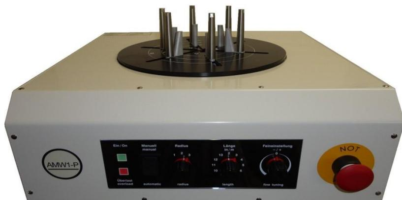
La machine AMW1-P est une solution efficace qui vous permet d'enrouler du câble déjà coupé rapidement et sans difficulté, à l'endroit souhaité.
