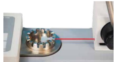
Fixation réglable de terminaisons de fil qui contient plusieurs fentes pour des diamètres de fils jusqu'à 6.3 mm
